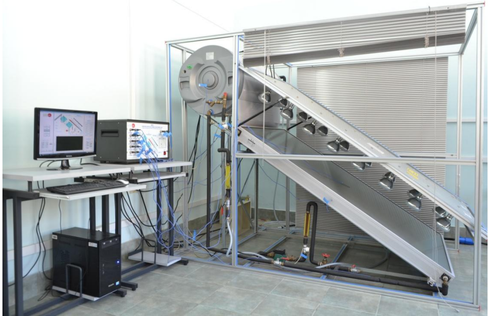
Equipo de energía solar térmica controlado desde PC
